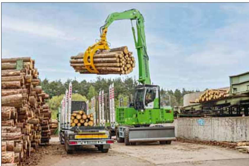
„735 E“ mit Holzgreifer inklusive integrierter Flyerkette beim Entladen
