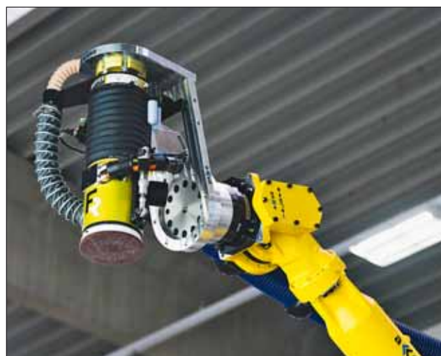
Der sensitive Schleifkopf kann mit einem Schleifteller für plane Flächen und einer Bürste z.B. für den Falz bestückt werden.
