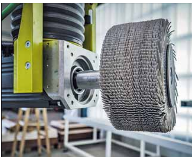
Der sensitive Schleifkopf kann mit einem Schleifteller für plane Flächen und einer Bürste z.B. für den Falz bestückt werden.
