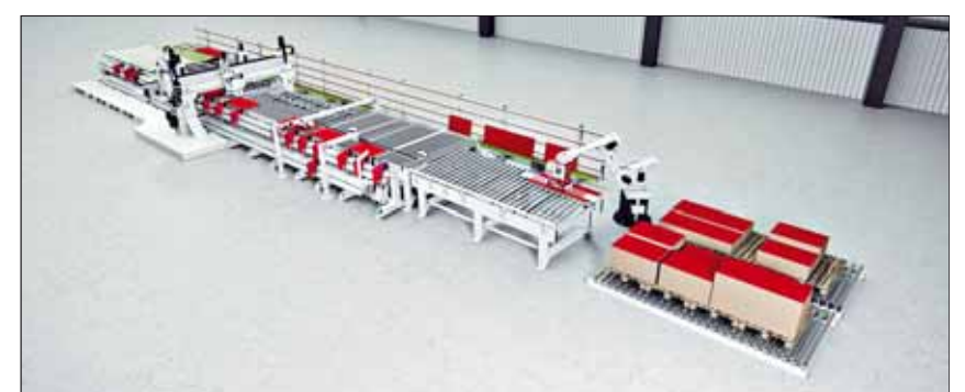
Durchlaufbohrmaschine „Imagic L1“ mit rüstoffreiem Bohrkonzept für die flexible Losgröße-1-Fertigung Foto: Ima Schelling Group
