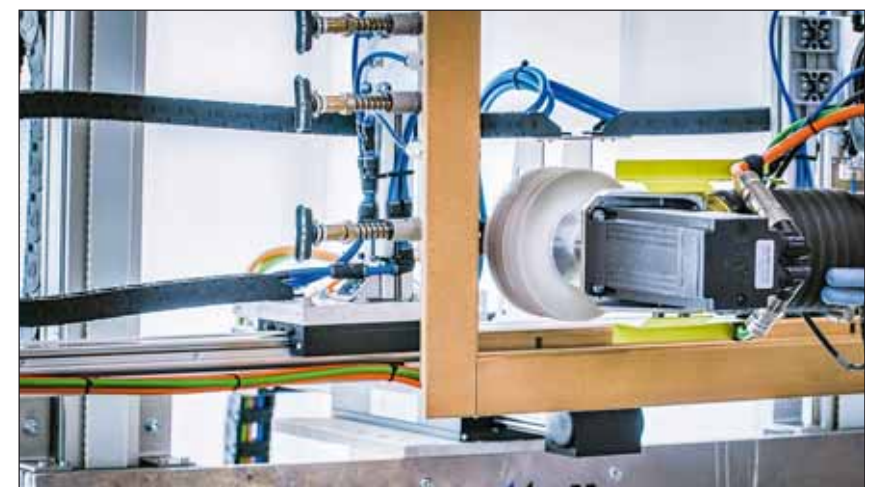
Eine automatische Erkennung der Konturen sorgt für einen exakten und gleichmäßigen Schliff.
