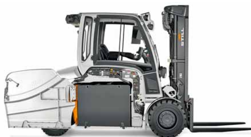
Zum schnellen Akku-Wechsel wird die seitliche Abdeckung um 180° nach hinten geschwenkt. Fotos: Still
