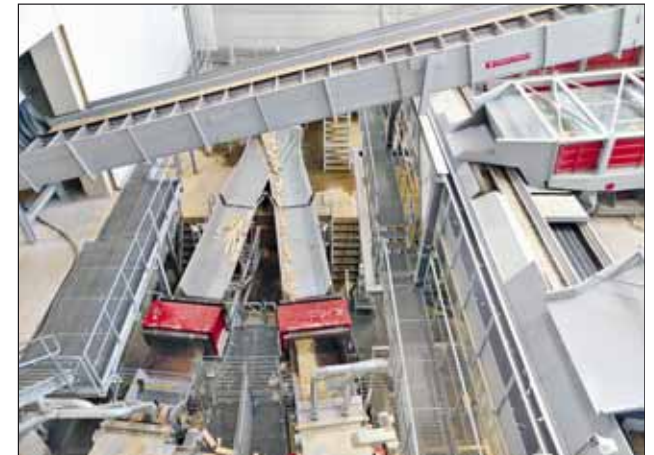
Zwei baugleiche Hacker, rechts eine der Siebmaschinen
