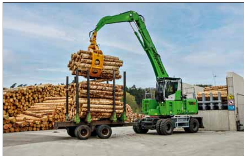
Einer von zwei Pick & Carry-Zügen, bestehend aus „735 E“ mit einem 30t-Trailers, die die neue Sägelinie beschicken Fotos: Sennebogen
